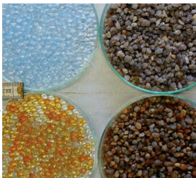
Abb. 2 Beispiel für den Fortschritt in der Entwicklung von Brunnenausbauaterialien: Vergleich von Glaskugeln und herkömmlichem DIN-Filterkies vor und nach einem Inkrustationsversuch an der Universität Bayreuth
